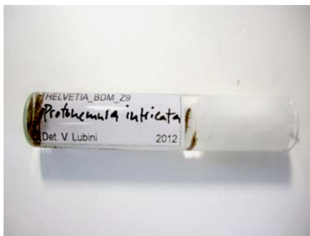
Abbildung 1: Anschauungsbeispiel eines Taxa-Glasröhrchens. Der Wattepfropfen ist an der Öffnung des Röhrchens zu positionieren und sollte nicht zu tief ins Röhrchen hinein gedrückt werden. Die Fundort- und die Bestimmungsetiketten sind so im Röhrchen zu positionieren, dass man von beiden Etiketten den Text vom Glasboden hin zur Öffnung lesen kann.
